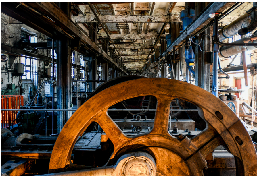
Bild 3 Ehemalige Brikettfabrik Knappenrode, Blick in die Pressenhalle der Fabrik I Die vorab gemahlene und getrocknete Kohle wurde hier mit der Kraft von Dampfmaschinen zu Briketts gepresst.
