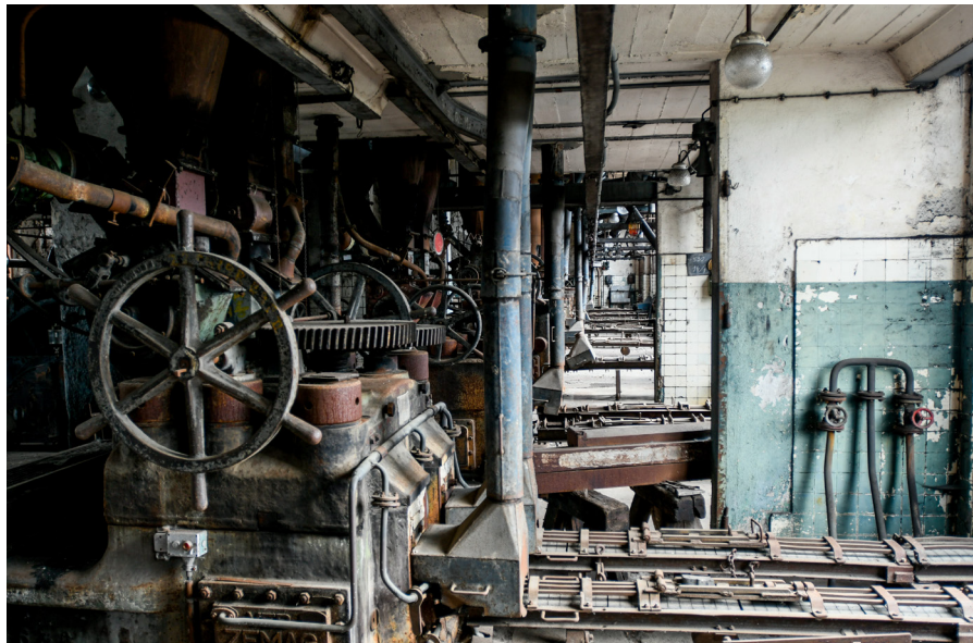
Bild 4 Doppelpresse vom VEB ZEMAG Zeitz mit den letzten Briketts in der Ausgabevorrichtung Die Pressen wurden mit Dampf oder Elektroantrieb betrieben.
